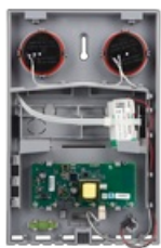
JA-163A-BASE-RB - partie inférieure de l'électronique
